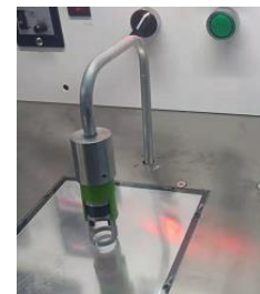
复检标记模块： 标记不良品，方便人工复检
