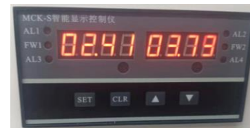
压力显示模块： 实时显示压辊压力值，避免产品压伤风险
